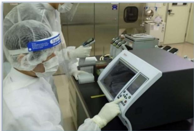
安全キャビネットの中で不活化した検体から RNA（核酸）を抽出する装置です。10月に導入した核酸自動抽出装置は、1回に24検体を約1時間で処理することができます。この装置により、従来よりも、作業効率が向上しました。検体が多い時には、3台の装置で抽出を行い、迅速な検査に貢献しています。
