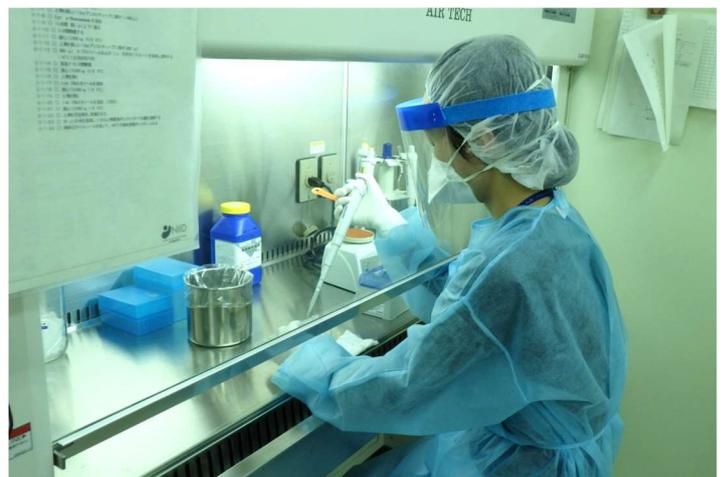
安全キャビネットは、高規格検査室の中に設置しています。感染性の高い検体を取り扱うため、作業エリア内を陰圧に保ち、病原体が外部に漏出するのを防ぐことで作業者を保護します。唾液等の検体はここで処理し不活化しています。
