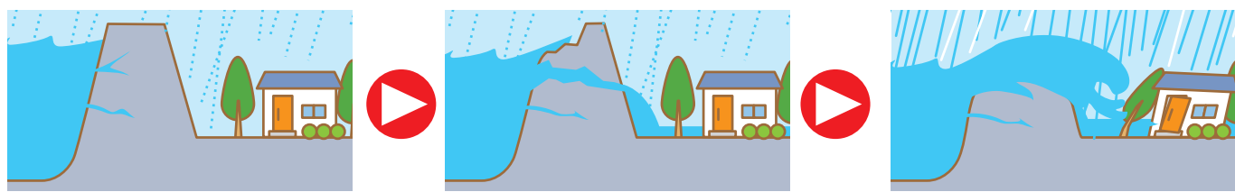
大雨などにより川の水が堤防いっぱいまで増え、堤防に水の圧力がかかり始めます。水が増え、水の力に堤防が耐えられなくなり、堤防の一部が崩れ始めます。堤防の崩れた場所は一気に広がり、勢いよく水が流れ出し、家に襲いかかります。
