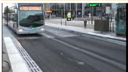
ホームと隙間なく停車する！自動ステップによって、乗りやすい！
