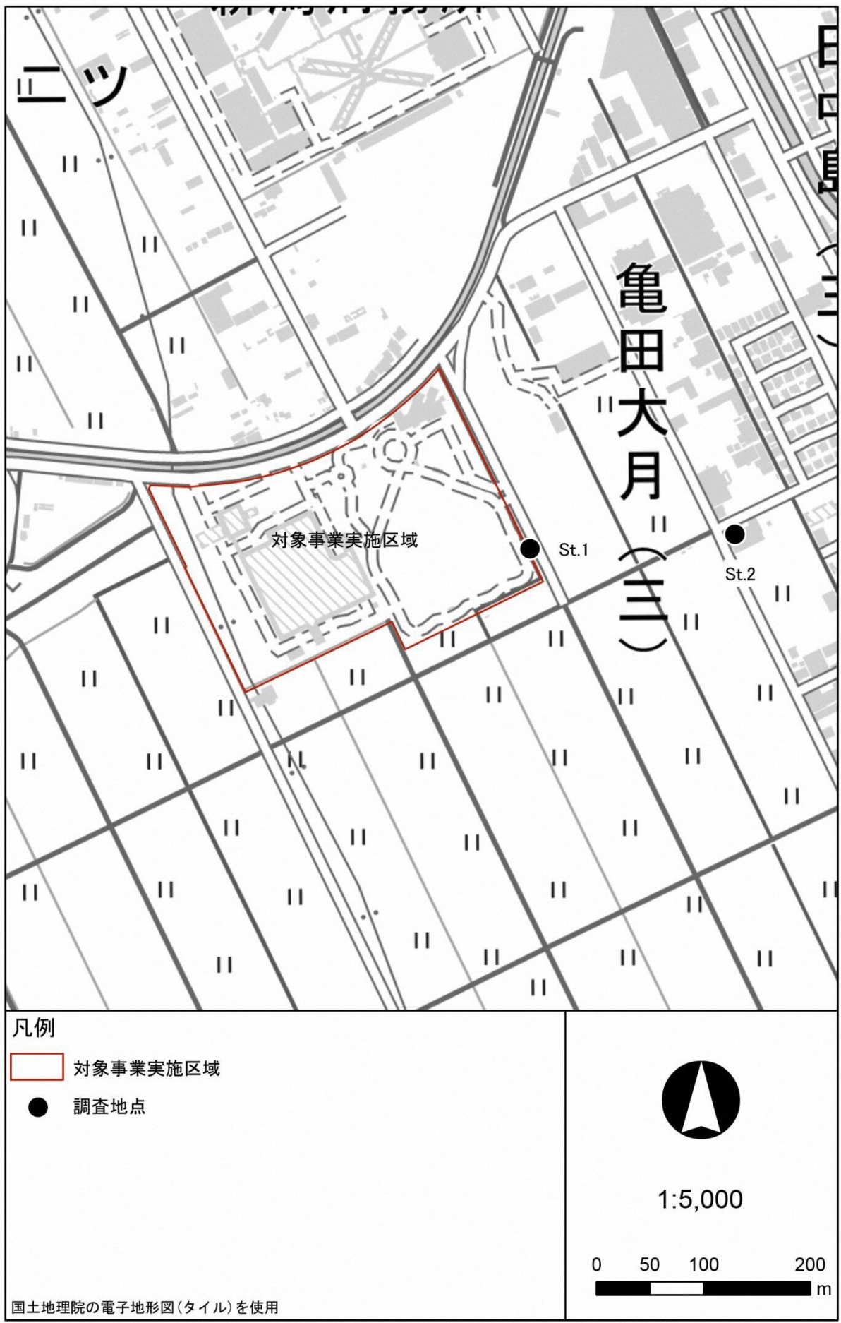
図 6.2.1 騒音の現地調査地点位置図 (建設機械の稼働)
