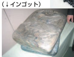
粉碎、洗浄、脱水を経て粒状(ペレット)にしたり、溶融してかたまり(インゴット)にし、プラスチック製品の材料として利用されます。
