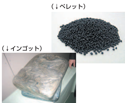
粉碎、洗浄、脱水を経て粒状(ペレット)にしたり、溶融してかたまり(インゴット)にし、プラスチック製品の材料として利用されます。
