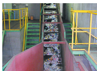
収集後、コンベアで破袋機に投入し、袋を破いた後、磁力でアルミ缶とスチール缶を選別します。
