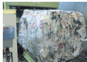
選別後、運びやすいように1辺1メートル、約300kgのかたまり(ペール品)にし、リサイクル業者に引き渡します。
