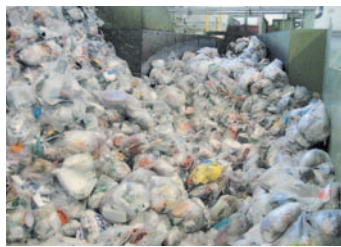
収集後、コンベアで破袋機に投入し袋を破ります。
