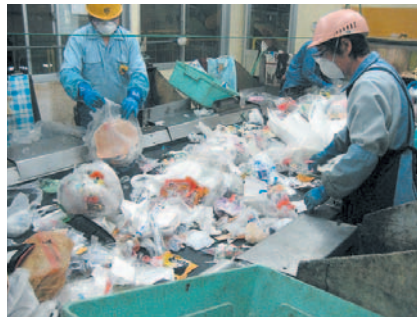
汚れたもの、中身が入っているもの、ペットボトル等の異物を手作業で取り除きます。
