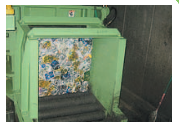
約65cm×65cm×20cmのブロックに圧縮します。
