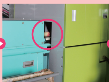
④透過式光センサーを移動しながら大きさ・色・糖度などを測定します。
