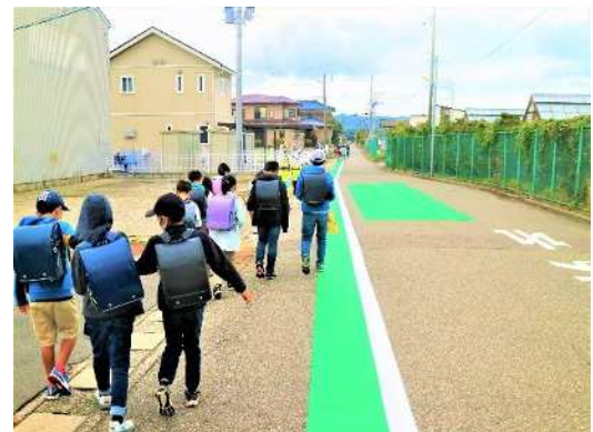
通学路に設置されたグリーンベルト
