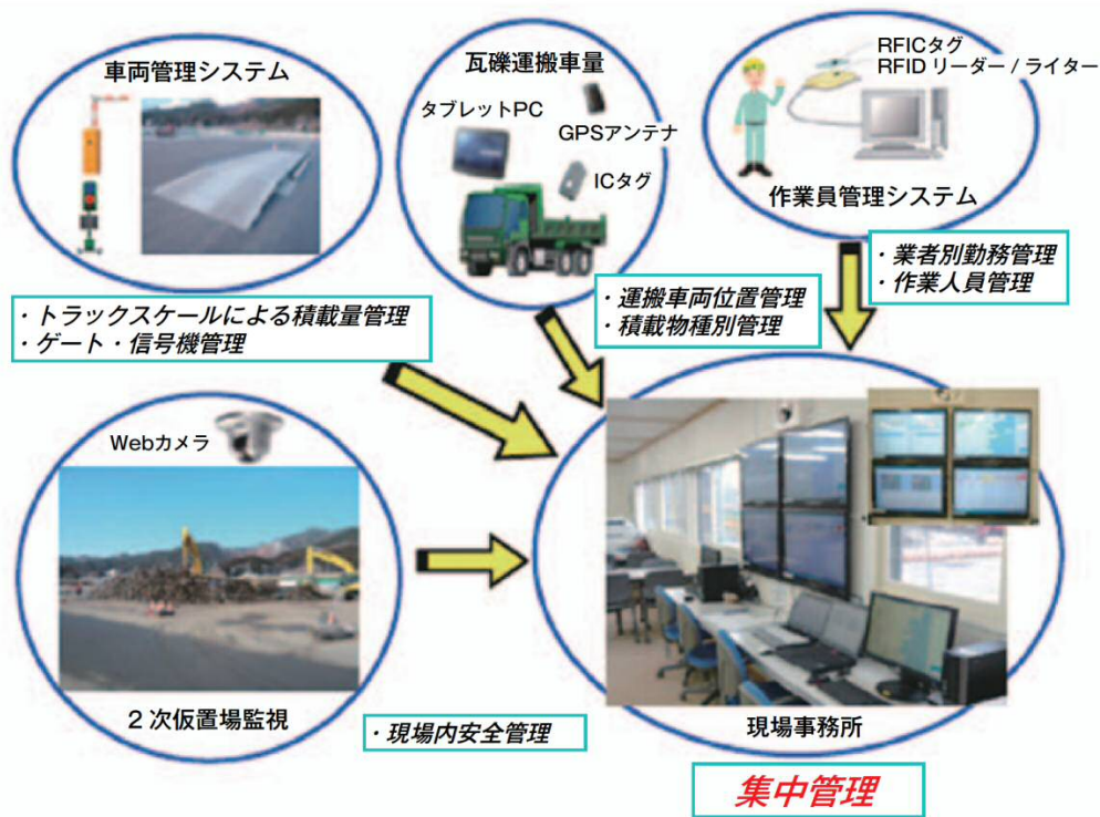
運行管理システムの概念図(岩手県大槌地区の例)
