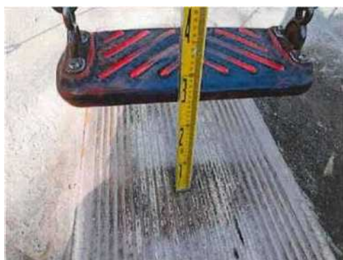
令和元年度点検状況 クリアランス 250mm
