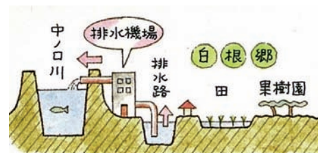
図1.2-3 排水機場の仕組み
