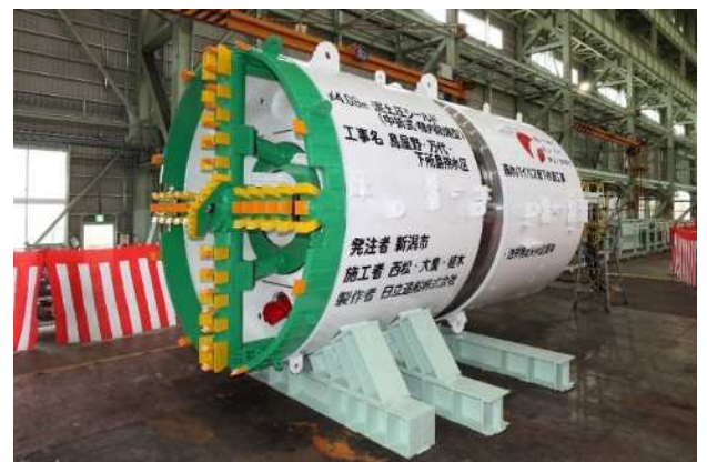
地中を掘進するシールドマシン
