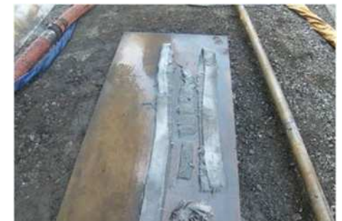
写真2 ドレーン材片
