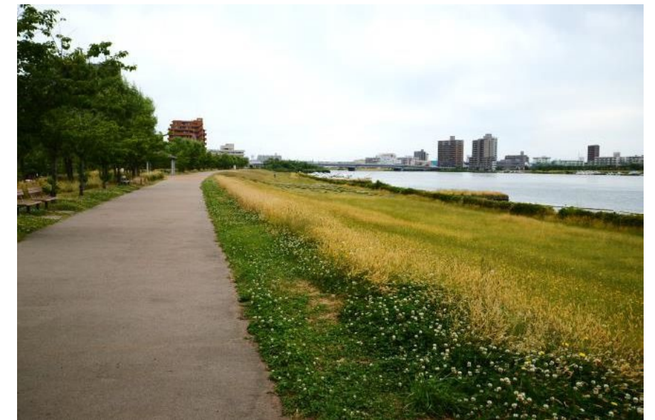
■縁石を植物が覆い、微妙な凹凸を持ったソフトなエッジになっている。園路線形も、不要なカーブは導入せずシンプルな方が美しく見える。
