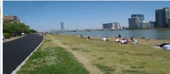
■流下能力に余裕がない当区間では、植樹基準(上記*1)から高水敷への高木植栽は困難な条件となっている。よって高水敷への高木植栽は実施せず、視線を遮るものない伸びやかなさを活かした景観づくりを目指す。(八千代橋下流)。
